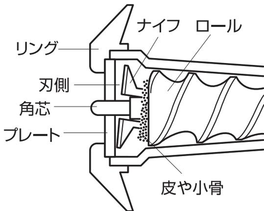
モーターを止めてコンセントから電源プラグを抜いた後、リングを外しプレートとナイフを取り出してください。魚等、骨のあるものを挽くとナイフとロールの間に皮や小骨が入り込みナイフが傾いた状態でプレートと接し、切れなくなるのが最大の原因です。ロール端面(角芯)に絡み付いたものを除去することにより解消されます(必ず保護具を着用すること)。
