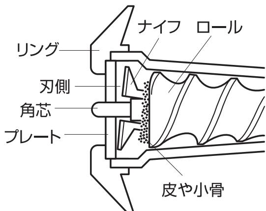
モーターを止めてコンセントから電源プラグを抜いた後、リングを外しプレートとナイフを取り出してください。魚等、骨のあるものを挽くとナイフとロールの間に皮や小骨が入り込みナイフが傾いた状態でプレートと接し、切れなくなるのが最大の原因です。ロール端面(角芯)に絡み付いたものを除去することにより解消されます(必ず保護具を着用すること)。
