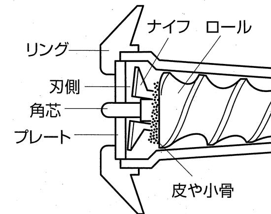
モーターを止めてコンセントから電源プラグを抜いた後、リングを外しプレートとナイフを取り出してください。魚等、骨のあるものを挽くとナイフとロールの間に皮や小骨が入り込みナイフが傾いた状態でプレートと接し、切れなくなるのが最大の原因です。ロール端面(角芯)にまとわり付いたものを除去することにより解消されます(必ず保護具を着用すること)。
