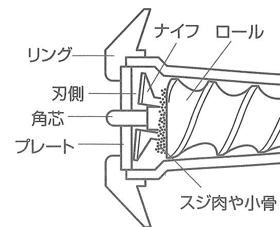
モーターを止めてコンセントから電源プラグを抜いた後、リングを外しプレートとナイフを取り出してください。ナイフとロールの間にスジ肉や魚の皮や小骨が入り込み、ナイフが傾いた状態でプレートと接し、切れなくなるのが最大の原因です。ロール端面(角芯)にまとわり付いたものを取り除くことにより解消されます(必ず保護具を着用すること)。
